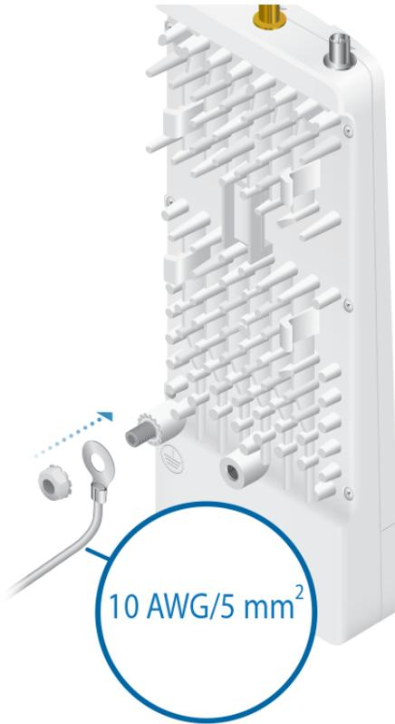
En el lugar de la instalación, asegure el otro extremo del cable de tierra a una toma de tierra, poste o barra de conexión de tierra.
